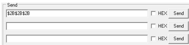
Envoyer la trame de passage en mode commande pour basculer le produit en mode de configuration, en cliquant sur le bouton SEND.
