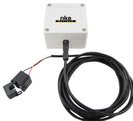
Le Capteur INTENS'O est un produit d'analyse associé à une pince ampérométrique qui se clipse simplement sur le conducteur électrique pour mesurer régulièrement le courant et transmettre périodiquement l'état de fonctionnement de l'équipement. Sur franchissement de seuils préalablement configurés, le Capteur transmet une alerte avec la mesure de courant associée, ceci à partir d'un réseau de communication public ou privé LoRaWAN™.
